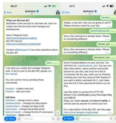
Gambar 10 Penginstalan Telegram Bot
