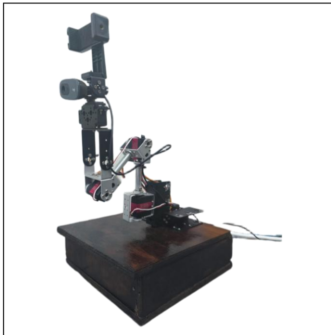
Gambar 4. Prototipe glambot SNAFH-R1: lengan kamera 4-DOF dengan tiga servo RDS3225MG dan satu servo MG995 yang dipasang pada dudukan kayu, dilengkapi dudukan kamera Logitech C270 dan holder smartphone.
